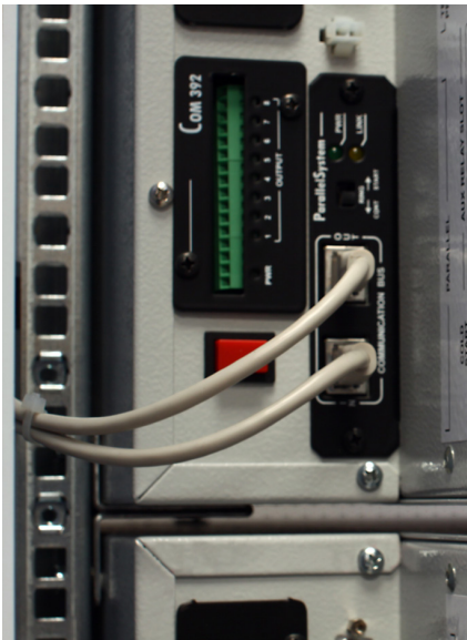
Параллельное подключение и плата контактов программируемых реле
