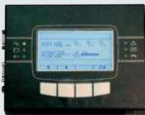
Multi Panel представляет собой удаленную панель, которая позволяет осуществлять дистанционный мониторинг ИБП и получать в режиме реального времени общую картину его работы. При помощи этого приспособления можно контролировать электрические параметры сети, состояние выхода, батареи и в целом состояние ИБП. Графический дисплей с высоким разрешением поддерживает 7 языков: английский, итальянский, немецкий, французский, испанский, русский и китайский.
