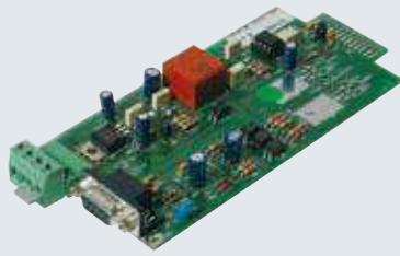
Аксессуар Multicom 372 позволяет получить на ИБП дополнительный порт обмена информацией в целях контроля и наблюдения за ИБП через последовательную линию RS232. Данная плата поставляется также с ESD-входом (для выключения ИБП в экстренных ситуациях) и с RSD-входом (для удаленного выключения), при этом оба размещаются на выдвижном клеммнике и подключаются непосредственно к кнопкам аварийного выключения и т.п.
