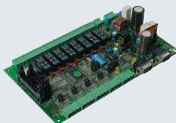
Полностью конфигурируемое устройство Multi I/O интегрирует ИБП в систему контроля посредством входных и выходных релейных сигналов. Оно позволяет подключать два устройства к одному порту последовательной связи ИБП.
