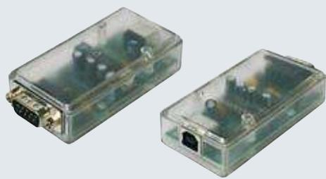
RS232-USB конвертор позволяет ИБП без USB-порта обмениваться информацией с персональным компьютером Apple Macintosh или с компьютером, имеющим операционную систему Windows или Linux. Программное обеспечение для обмена информацией **PowerShield<sup>3</sup>** поддерживает соединение через USB-порт без установки дополнительных драйверов.
